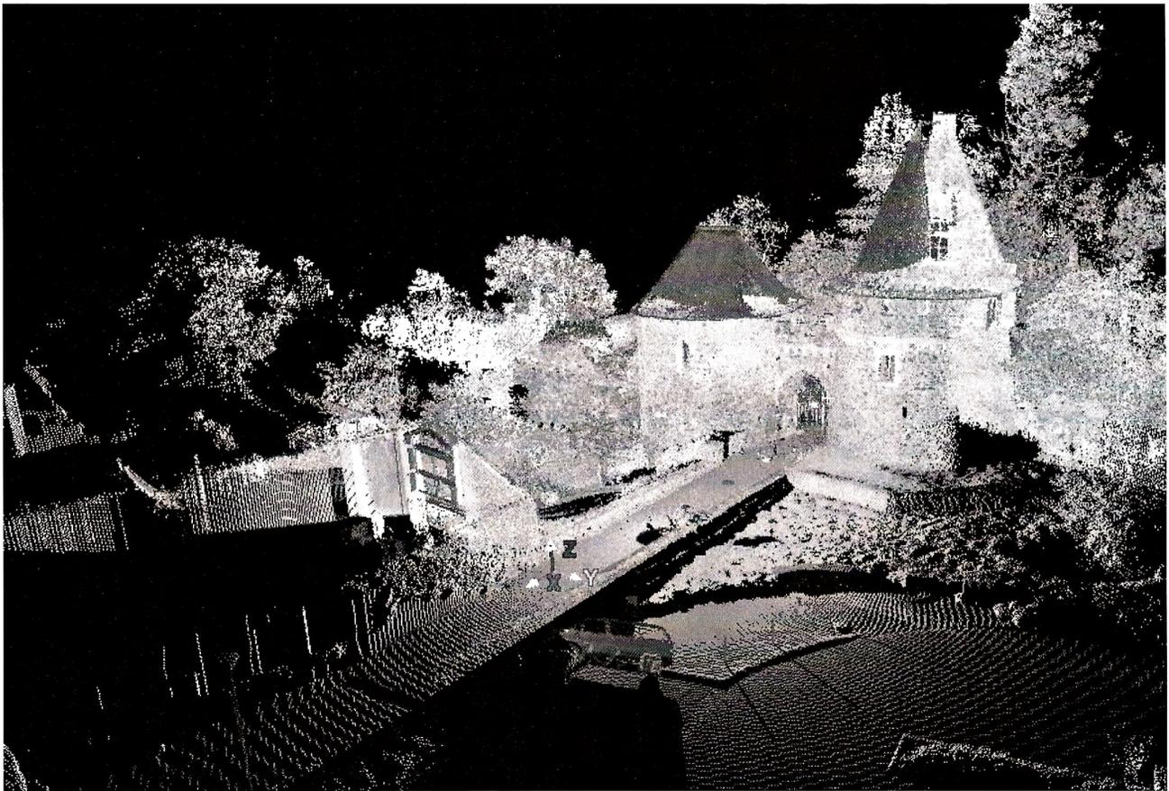
Fig. 2 : un des nuages de points obtenus à l'aide du scanner 3D
